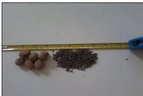
Figura 5 – Material suporte utilizado no experimento, antes e depois de submetido ao tratamento físico
