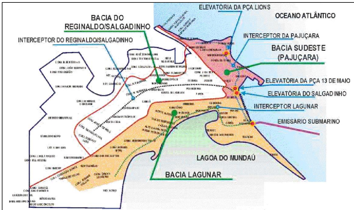
Figura 2 – Principais interceptores e elevatórias do sistema de esgotamento Sanitário de Maceió.
