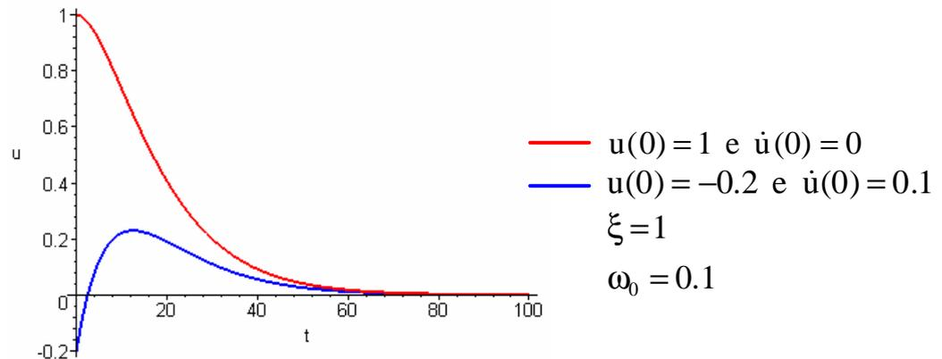
O amortecimento crítico representa o limite para o movimento não periódico e, conseqüentemente, o movimento retorna ao repouso no menor prazo, sem qualquer oscilação.
