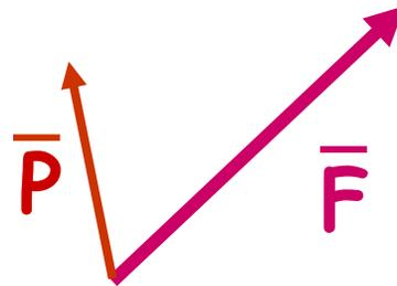
O segundo componente é obtido aplicando-se a *regra do triângulo* unindo-se a ponta do componente conhecido à ponta da força original.
