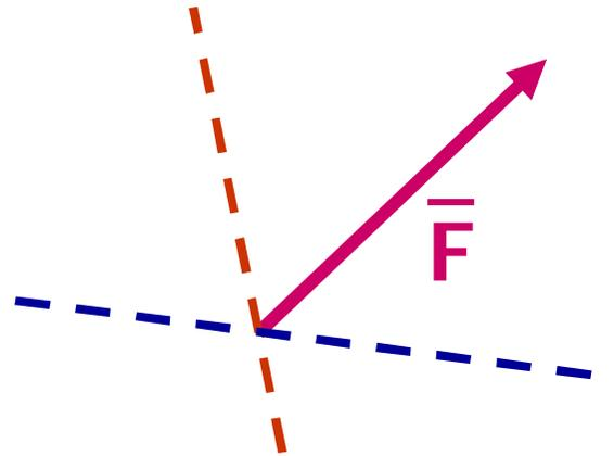
A intensidade e o sentido dos componentes são obtidos aplicando-se a *lei do paralelogramo* traçando-se retas, a partir da ponta da força original, paralelas às linhas de ação dadas.
