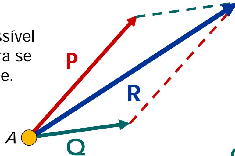
O mesmo vetor força resultante pode ser determinado combinando-se os dois vetores força originais na seqüência *ponta-a-cauda* e, em seguida, unindo-se a cauda do primeiro desenhado à ponta do segundo desenhado.
