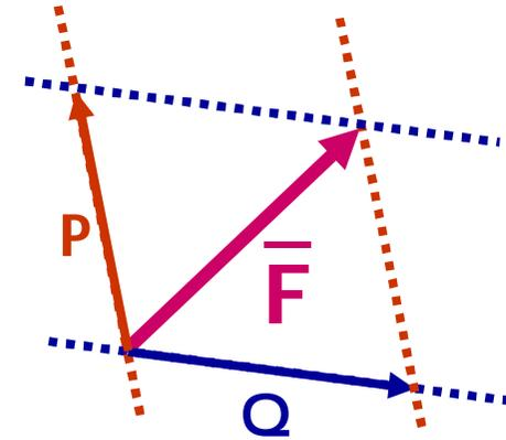
Estabelecendo direções de decomposição perpendiculares, o paralelogramo se transforma num retângulo, o que leva a expressões analíticas simples para os componentes da força (componentes cartesianos ou retangulares).
