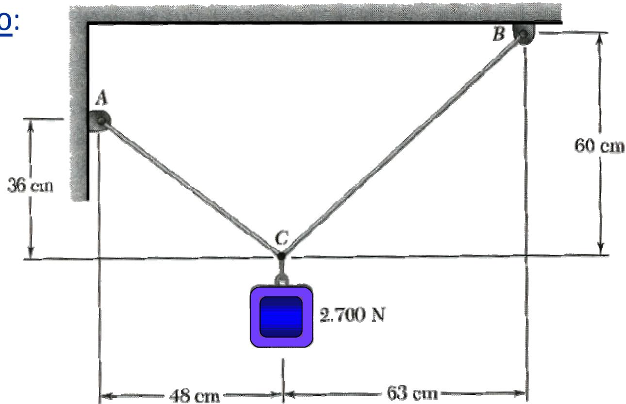
Dois cabos estão ligados em  $C$  e são carregados tal como mostra a figura. Visando a especificação dos trechos de cabo  $AC$  e  $BC$ , determine as trações nos mesmos.
