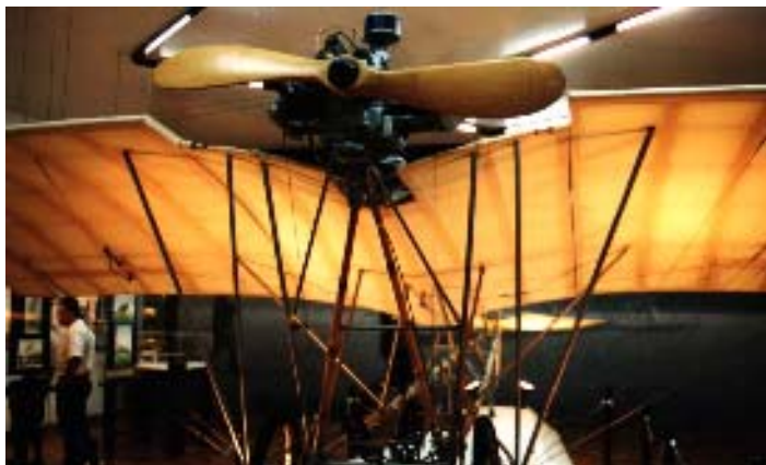
Ilustração 6: Réplica do Demosielle , Avião projetado e construído com varas de bambu, por Santos Dumond.
