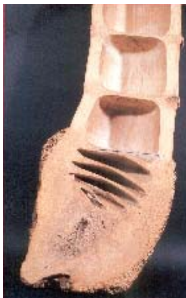
Ilustração 8: Estrutura interna (seca) do bambu destacando colmos, nós e rizoma.
