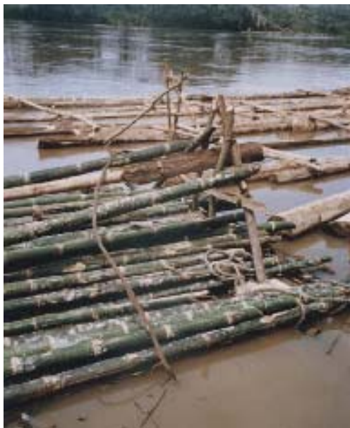
Ilustração 16: Esquema de cura do bambu na água corrente.
