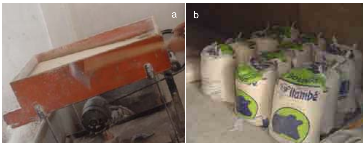
Figura 3.5. Atividades para processamento da mandioca. (a) peneiramento; e (b) ensacamento.
