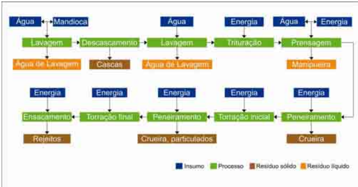
Figura 3.6. Processamento da mandioca para produção de farinha. Fonte: SEBRAE (2006).
