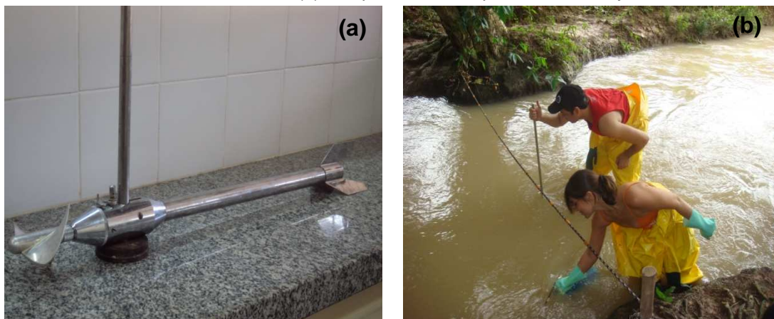
Figura 4.13 – Medição de vazão na bacia do rio Jacarecica em Maceió-AL: (a) molinete Fluviométrico e (b) campanha de campo no dia 08 de julho de 2010.
